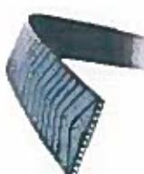
Sistemul de tractiune cu banda de poliuretan cu insertie metalica, roata de frictie, aderenta foarte mare, actionare fara alunecari, sistem de protectie la depasirea vitezei de mers in sus. Datorita folosirii benzii de poliuretan in loc de cablu de otel rotund, actionarea este foarte silentioasa si sigura.
